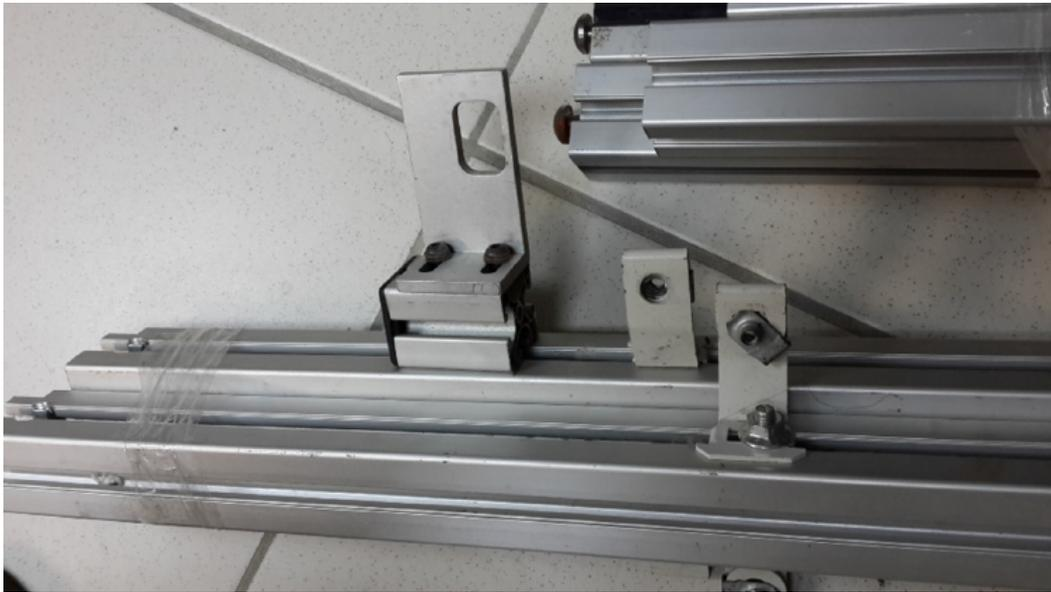
Figura 6.5: Perfiles industriales de aluminio utilizados (Imagen tomada de [10]).
