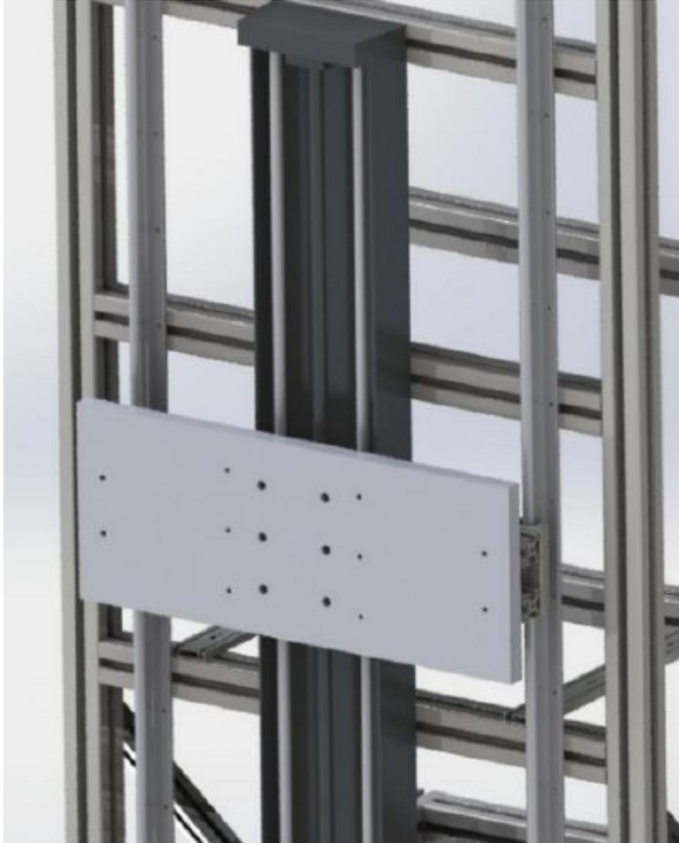
Figura 5.9: Sistema de desplazamiento vertical.
