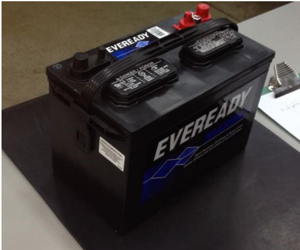
Figura 7.1: Batería de ciclo profundo adquirida para la base móvil del robot humanoide.
