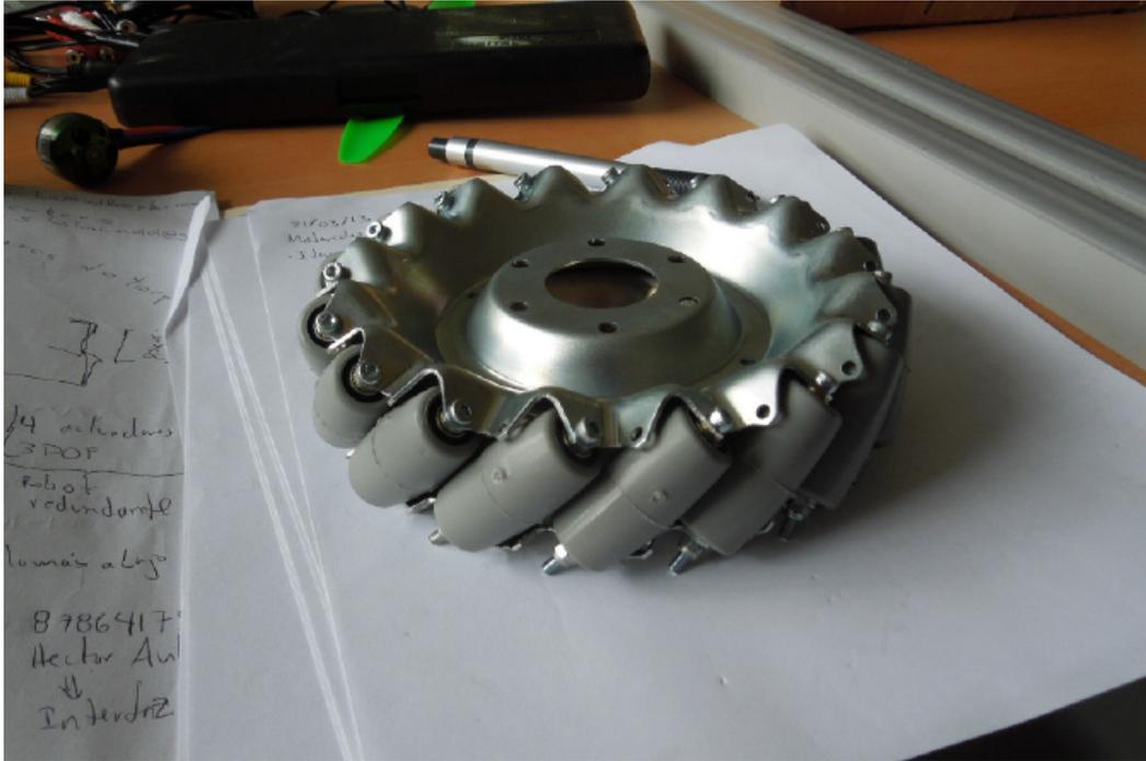
Figura 6.4: Rueda tipo mecanum Andymark de 6 pulgadas (Imagen tomada de [10]).
