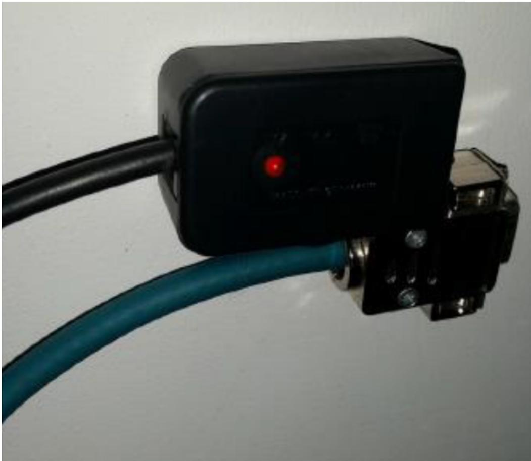
Figura 5.16: Cable ethernet industrial usado entre la mano y el controlador.
