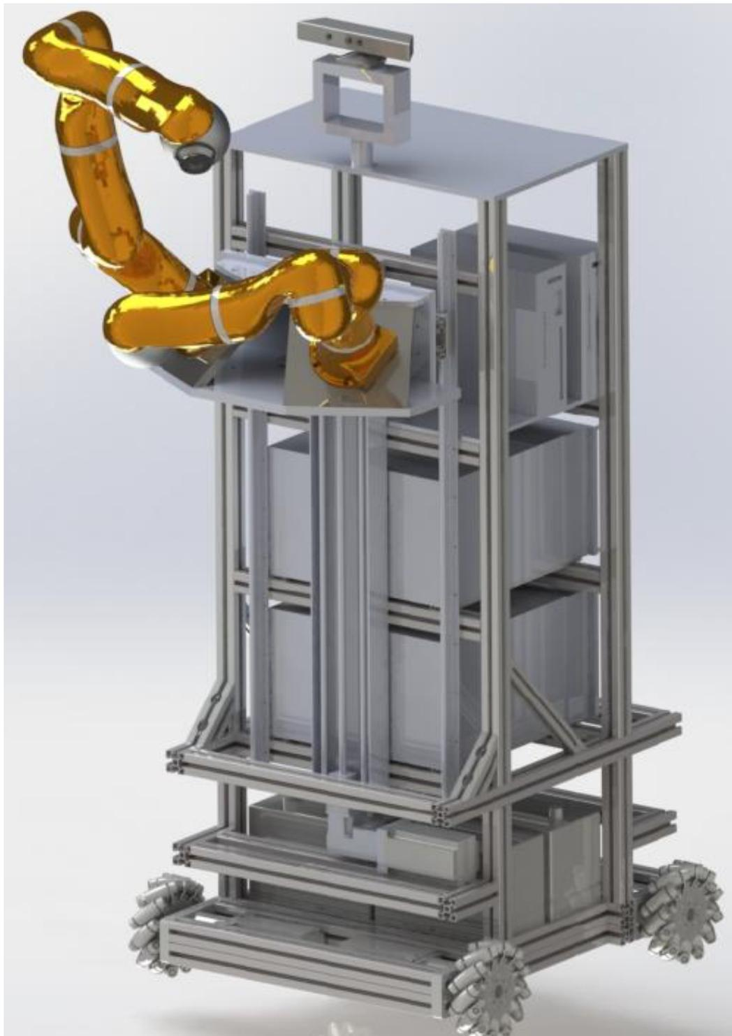
Figura 5.10: Diseño final del torso del robot humanoide.
